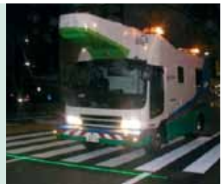
路面測定中の「ロードスキャン」
