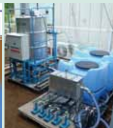
簡易薬液注入装置
