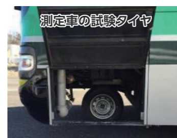
測定車の試験タイヤ 転がり抵抗の測定方法については、測定車のタイヤ空気圧、タイヤ
