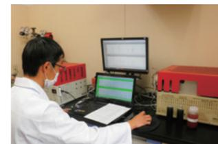
現場で採取した試料(汚染された土や水)を使用予定の薬剤で試験し、汚染の濃度経過を測定。結果によって浄化工法の提案をしている。
