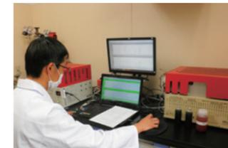
現場で採取した試料(汚染された土や水)を使用予定の薬剤で試験し、汚染の濃度経過を測定。結果によって浄化工法の提案をしている。
