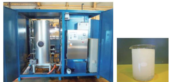
微細なマイクrobialオゾン(写真左:MBO)で汚染物質を分解・無害化する【MBO促進酸化処理工法】。浄化の過程で発生するのは酸素のみで、廃棄物の発生を低減。また装置は低騒音・低振動のため市街地でも稼働可能
