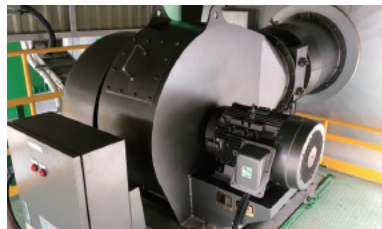
新潟合材工場：環境対策として、都市ガス用の高効率バーナに更新。
