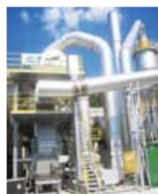
環境対策としてハイブリットバーナおよび脱臭炉を導入した例(岡崎合材工場)
