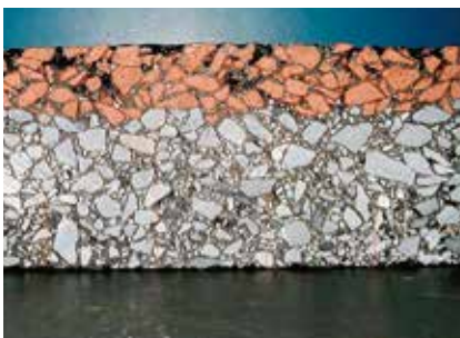
施工断面例 (上層:排水性舗装(赤色)、 下層:一般舗装(黒色))
