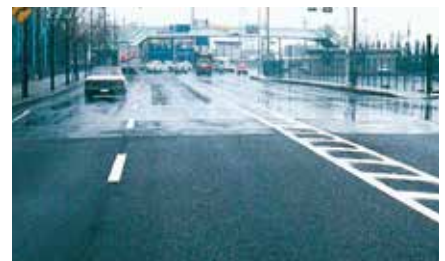
雨天での供用状況 (手前：パーピアス、 奥：一般的な舗装)
