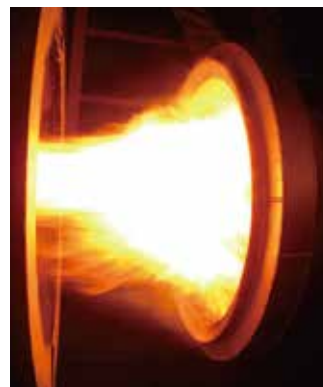
ハイブリットバーナの燃焼状態: 理想的な空気比で効率的な燃焼が維持される
