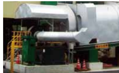
岡崎合材工場に導入した都市ガス省エネ型バーナ
