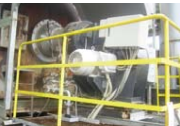
紫竹合材工場に導入した都市ガス省エネ型バーナ
