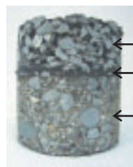
現場切り取り供試体
