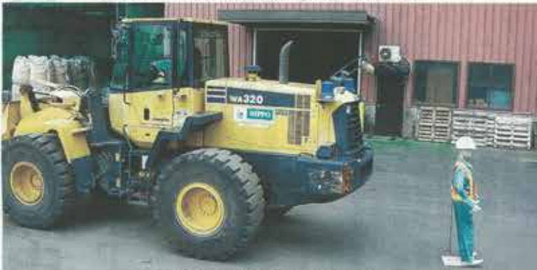
人を検知し自動停止するWSSシステム
