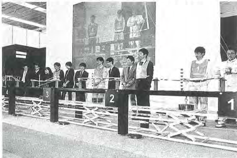
橋梁模型製作コンテストの載荷試験
