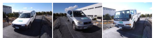
写真-3 車両走行実験状況 (沈下量 550mm)
