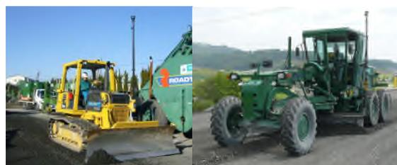
写真-4 3D-MC用ブルドーザとモータグレーダ
