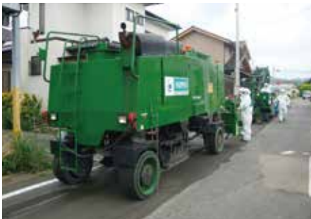
福島県で実証実験を行った薄層切削路面除染システム
